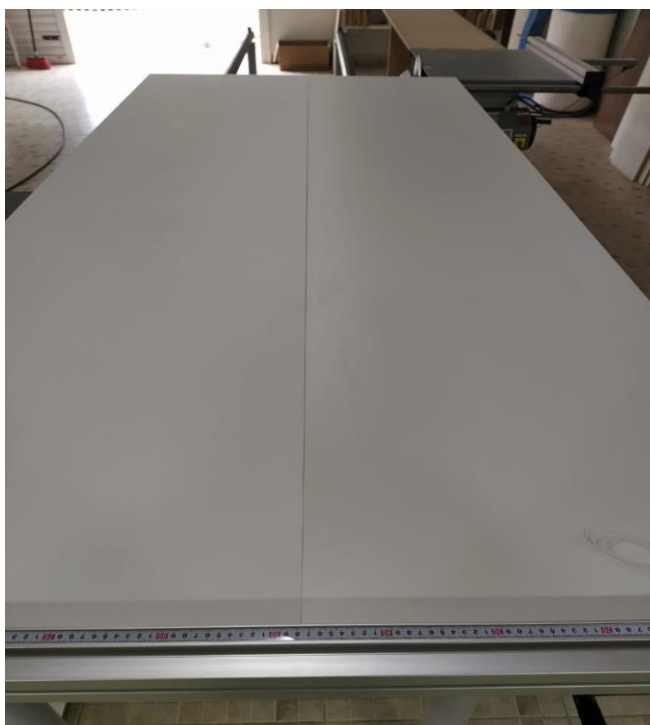
ILUSTRAÇÃO DE UM CORTE COM O TRILHO 100% ALINHADO
